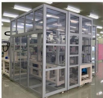
产品介绍：3D OCA Lamination 设备是将 Flexible OLED Panel 和 Cover Glass 附着为 OCA，它的优点是能够应对最近其需求量正在增加的多种形态的“Flexible OLED Panel”。比如 Samsung 的 Galaxy
